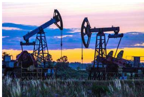
Мал. 230. Насосний спосіб видобутку нафти
